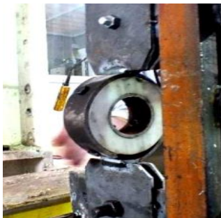
شکل ۱۶- حلقه فولادی پر شده با تفلون (پلاستیک صنعتی) [۲۳]
