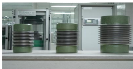
شکل ۲۰- نمونه‌های مورد آزمایش لوله‌های جدار نازک آکاردئونی [۲۷]
