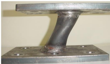
شکل ۲۸- نمونه‌ای از تغییر شکل پلاستیک میراگر لوله‌ای در شرایط آزمایشگاهی [۳۵]
