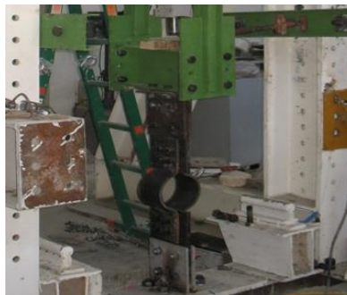
شکل ۱۲- بررسی نیم حلقه‌های فولادی در اثر بارهای رفت و برگشتی [۲۰]
