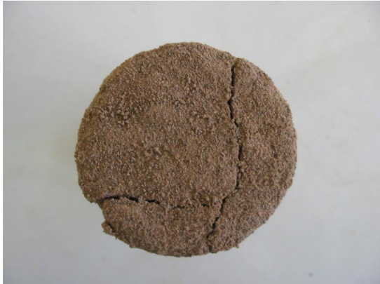
شکل ۱۵- نمونه ترک خورده حین انجام سیکل‌های ذوب و یخ (با ۵٪ پوزولان).
