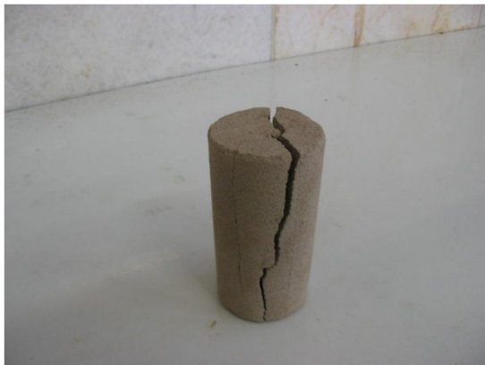
شکل ۱۵- نمونه پکیده شده حین انجام سیکل‌های ذوب و یخ (با ۲۰٪ پوزولان).
