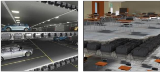
شکل ۲- کاهش تعداد ستون‌ها با استفاده از سقف‌های کوبیاکس
