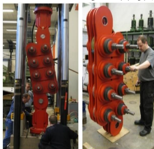
شکل ۳ تست میراگر اصطکاکی دورانی ظرفیت بزرگ در آزمایشگاه دانشگاه دانمارک
