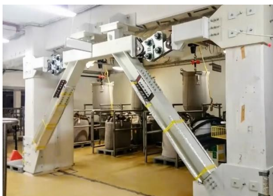
شکل ۴ - استفاده از RFD در قاب یک سازه فولادی با بادبند شورون
