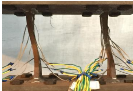
شکل ۵- هندسه تغییر شکل یافته در نمونه عددی و مدل صحت سنجی
