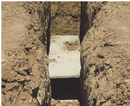
شکل ۷- تونل جعبه ای شکل مورد بررسی مدفون در خاک در مطالعه ی سهیلی و همکاران [۲۰]
