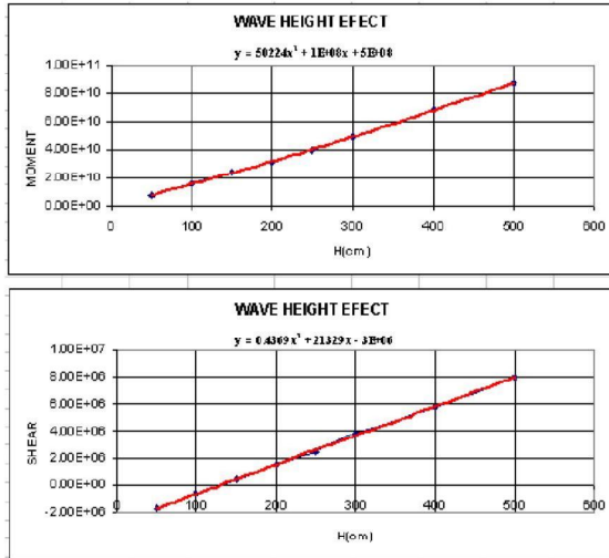
شکل (۱۹) تاثیر ارتفاع امواج برخوردی با فرکانس ۰/۱ ثانیه در واکنشهای شناور
