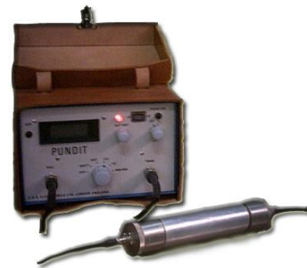
شکل ۴- دستگاه PUNDIT مورد استفاده در پژوهش
