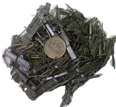
شکل ۳- الیاف فولادی مورد استفاده در پژوهش
