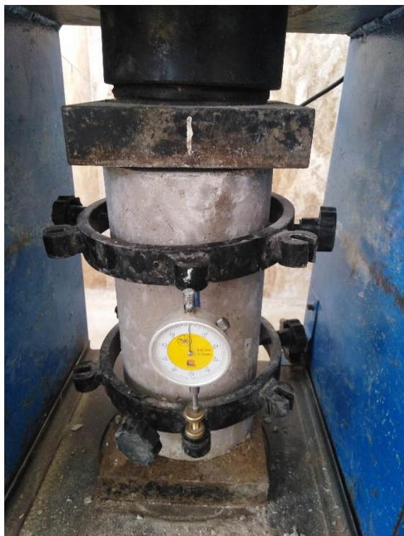
شکل ۵- نمونه بتنی تحت آزمون مدول الاستیسیته
