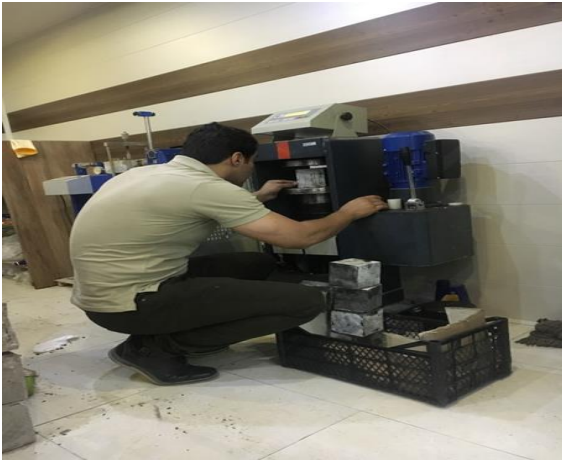
شکل ۹- بارگذاری نمونه‌های ساخته شده [۱۲].
