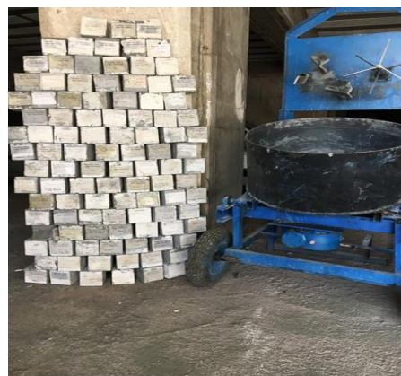
شکل ۱۱- نمونه‌های مکعبی UHPC تست شده مربوط به جدول ۲
