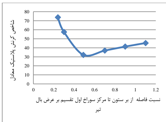
شکل ۱۸- مقایسه نمودار شاخص کرنش پلاستیک معادل جوش نفوذی در وسط تیر
