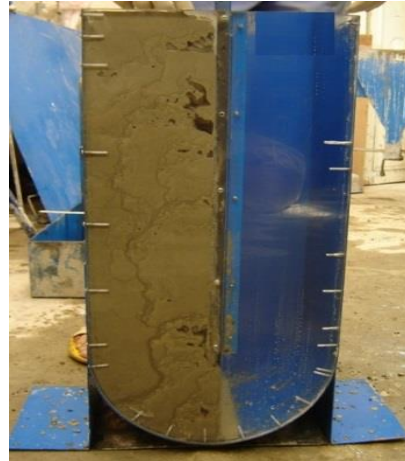
شکل شماره ۴- نمونه ای از نحوه انجام آزمایش یو
