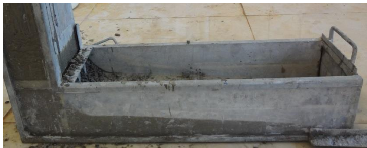
شکل شماره ۶- نمونه ای از نحوه انجام آزمایش جعبه L
