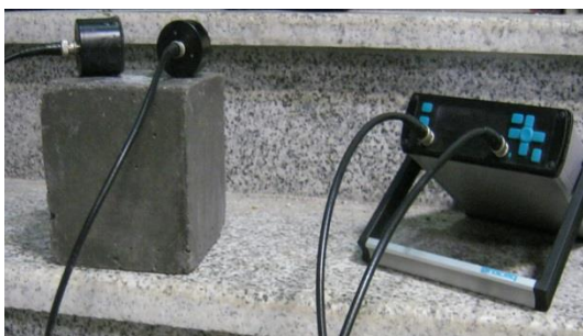
شکل شماره ۱۰- نمونه‌ای از انجام آزمایش فراصوتی
