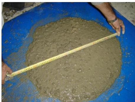
شکل شماره ۲- نمونه‌ای از نحوه انجام آزمایش جریان اسلامپ
