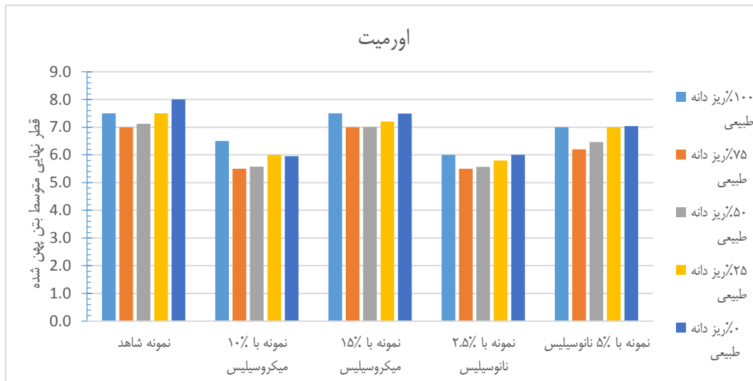
نمودار شماره ۸ - تغییرات قطر نهایی متوسط بتن با درصدهای مختلف ریز دانه طبیعی و بازیافتی در آزمایش جریان اورمیت
