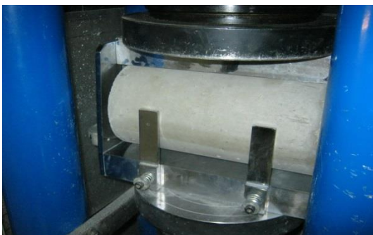
شکل شماره ۸- نمونه‌ای از انجام آزمایش مقاومت کششی
