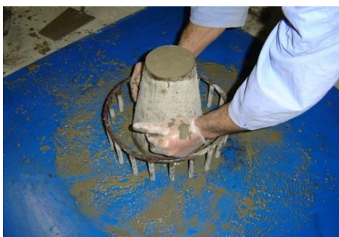
شکل شماره ۳- نمایی از نحوه انجام آزمایش حلقه جی
