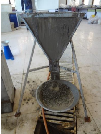
شکل شماره ۵- نمونه ای از نحوه انجام آزمایش قیف V
