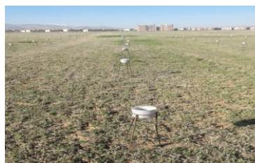
شکل ۵- نمایی از آرایش ظروف جهت تعیین ضرایب CU و DU
