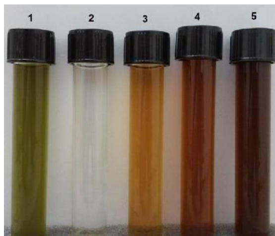
شکل ۱. تغییر رنگ محلول واکنش سنتز نانوذرات نقره. (۱) عصاره گیاه. (۲) محلول نیترات نقره (۳، ۴ و ۵) مخلوط واکنش عصاره
