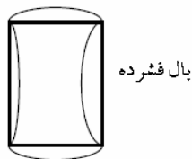
شکل (۵): مود تغییر فرم لوله جدار نازک تحت زاویه ۳۰ درجه [۱۰]
