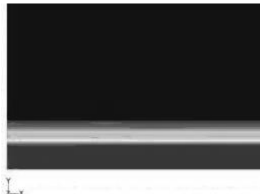
شکل (۹): لایه مرزی گرمایی در مسیر جریان هوا در حفاصل بین سوراخها در آرایش مربعی
