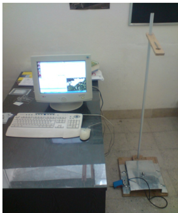
شکل (۶): تجهیزات آزمایشگاهی انجام تست مقاومت به فرورفتگی دینامیکی به همراه سنسور متصل به کامپیوتر
