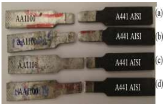
Fig. 12 Fracture specimens of (a) 0.1, (b) 0.2, (c) 0.4, and (d) 0.6 mm plunge depth
