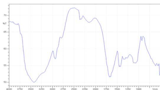
شکل ۴: طیف FTIR مربوط به نانوکامپوزیت بدون سدیم مونتوریلونیت
