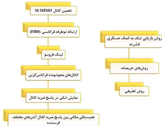
شکل (۱): بلوک دیاگرام روش تخمین کانال مورد استفاده در این مقاله Figure (1): Block diagram of channel estimation method used in this article
