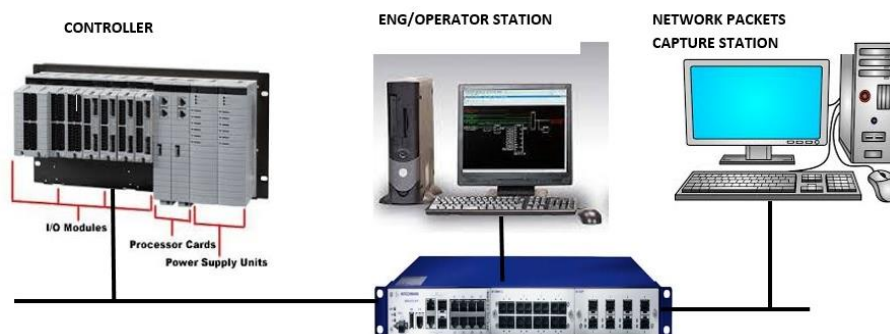
شکل (۶): مجموعه تست سیستم کنترل یوگواوا
