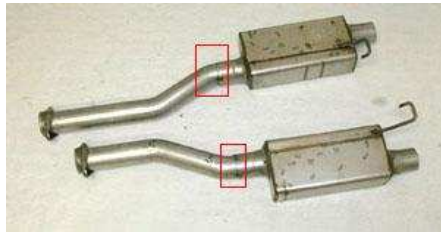
شکل ۲. اتصال جوشی لوله ها در آگروز خودرو [۲]
