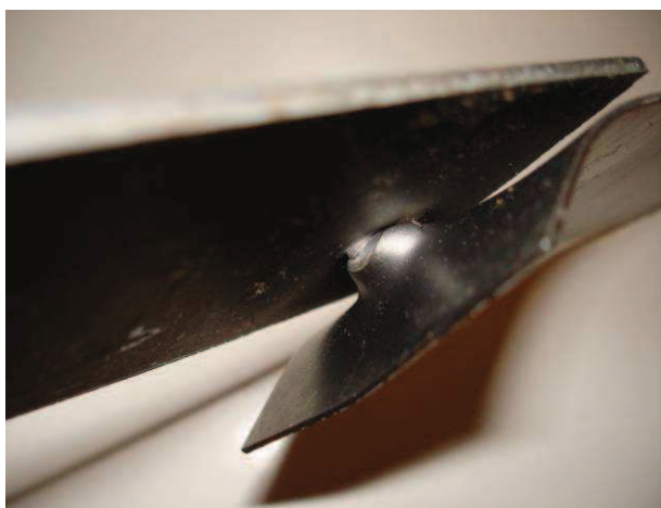
شکل (۱۰): بیرون کشیده شدن دکمه‌ی جوش از ورق نازک‌تر حین تست کشش-برش
