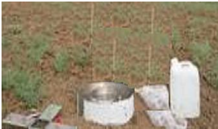
شکل ۳: اندازه گیری مقادیر نفوذ خاک در کاربری مرتعی از طریق استوانه مضاعف.
