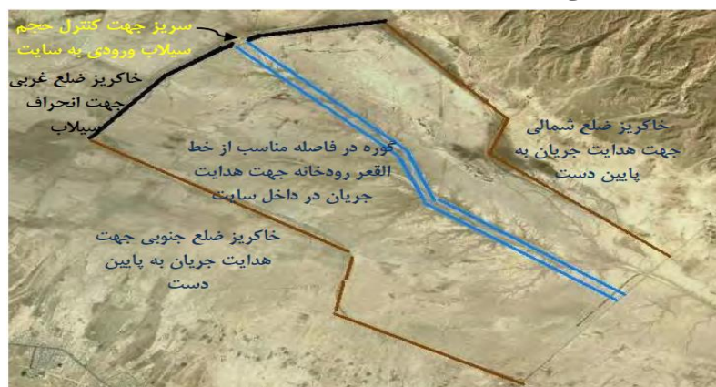
شکل ۱۳: نحوه قرار گیری خاکریز محاط کننده سایت و دیوار گوره در دو سمت خط القعر رودخانه
