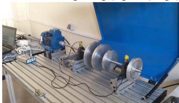
شکل ۱: مدل سیستم دوار ساخته شده برای آزمایش
