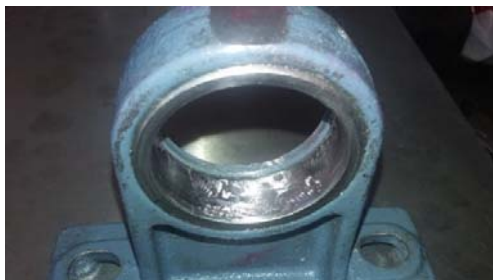
شکل ۲: شیارهای ناهمگون ایجاد شده در یاتاقان بعنوان یک عیب مکانیکی
