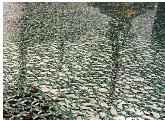
شکل ۵ وضعیت شیشه نشکن پس از شکست [۱۵]
