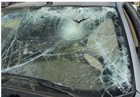
شکل ۳ وضعیت شیشه جلو خودرو پس از شکست [۱۳]
