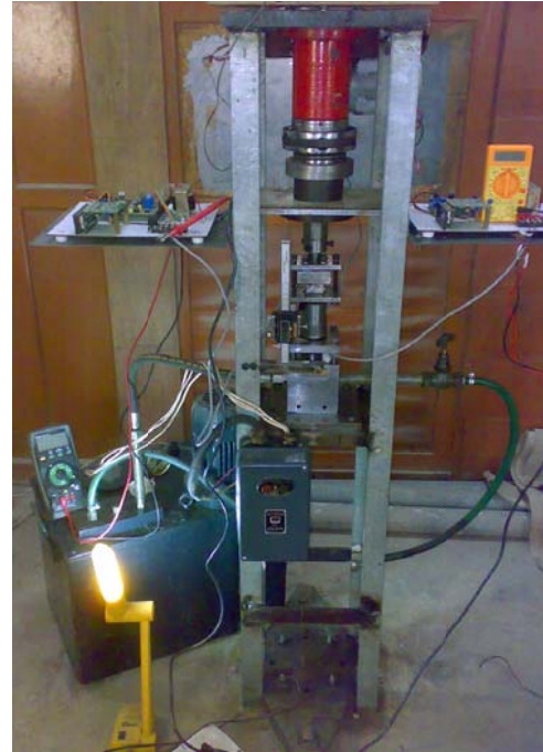
شکل ۸ دستگاه ساخته شده هیدروفورمینگ ورقه ای
