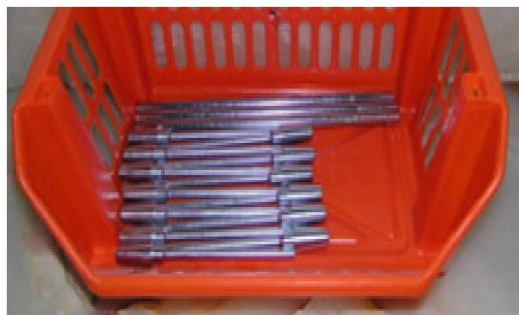
شکل ۹ قطعات پس از فرآیند آبکاری و آماده برای تست خستگی
