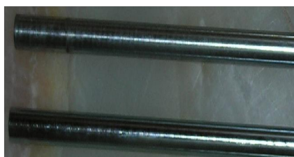
شکل ۴ قطعات نهایی آماده شده برای تست کشش
