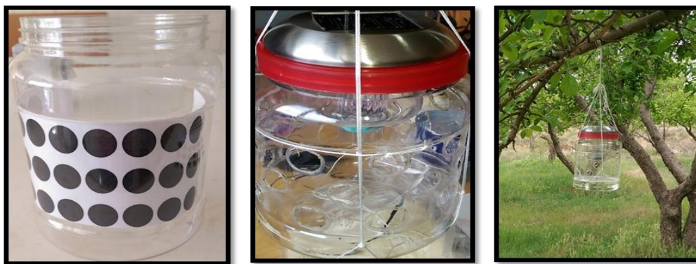
شکل ۱- ظروف تله‌های نوری ساخته شده با استفاده از پلاستیک با جنس پلی‌اتیلن تترافتالات (PET)
