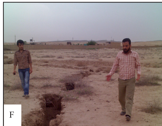
شکل ۸- توسعه شکستگی ها ی طولی در امتداد دشت گرمسار و ایوانکی و فرونشست زمین
