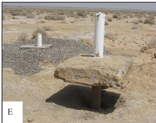
شکل ۸- توسعه شکستگی ها ی طولی در امتداد دشت گرمسار و ایوانکی و فرونشست زمین
