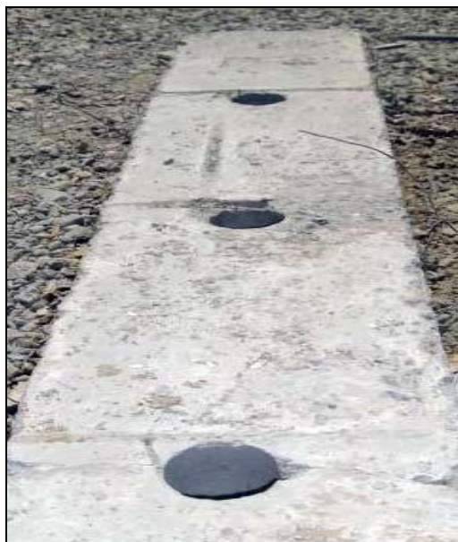
شکل ۳- ستون بتنی و موقعیت چال‌های حفر شده در آن (قطر چال ۴۴ میلی‌متر، فاصله‌داری ۳۵ سانتیمتر)
