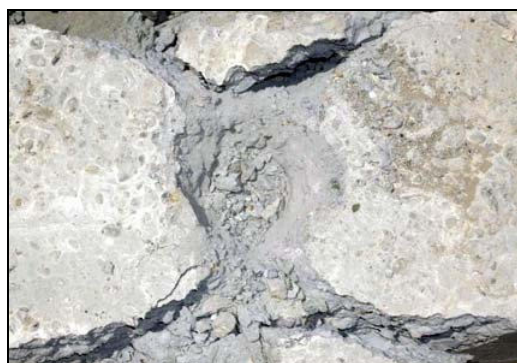
شکل ۵- انفجار یک چال (به قطر ۴۴ میلیمتر) با ۲۸۴ گرم دینامت در ستون بتنی ضخامت ستون ۲۰ سانتیمتر
