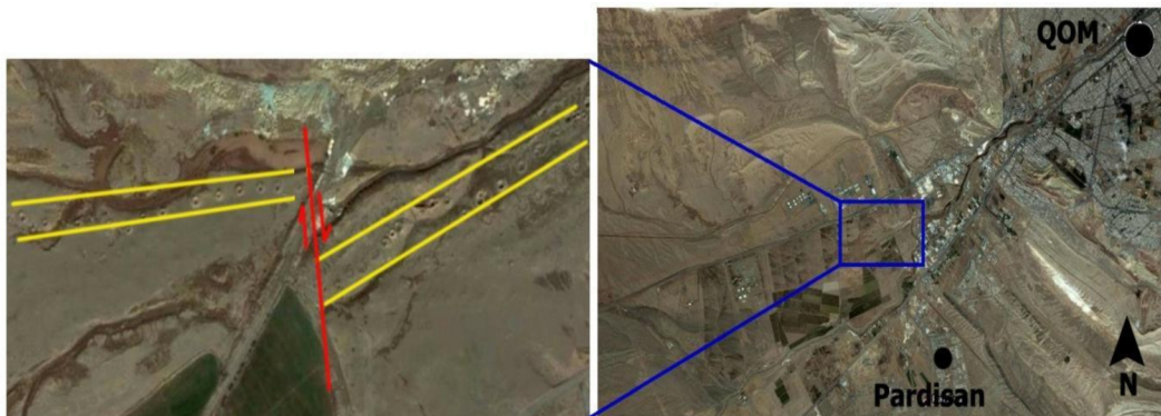
شکل ۵- عکس ماهواره ای گسل قم (برگرفته از Google Earth) که آبراهه ها و قنات های جنوب باختر قم را در حدود ۱۳۰ متر جابه جایی کرده است.
