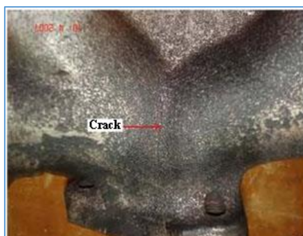
شکل ۱۰: منی فولد دود گسیخته شده در ناحیه هم‌ریختگاه در تست شوک حرارتی [۳۲]
