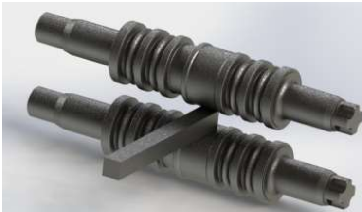
شکل (۱): مدل شبیه‌سازی شده فرآیند نورد در پاس اول در نرم‌افزار Solidworks.
