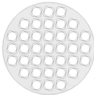
شکل ۱: بافل منفذدار کوآتر فویل با آرایش مربع
