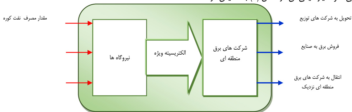
شکل شماره (۳): شبکه برق ایران شامل بخش تولید و توزیع
