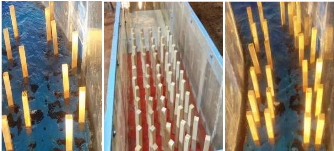
شکل ۳: نمونه ای از موانع مربعی در قوس و مسیر مستقیم با آرایش زیگزاگ و موازی
