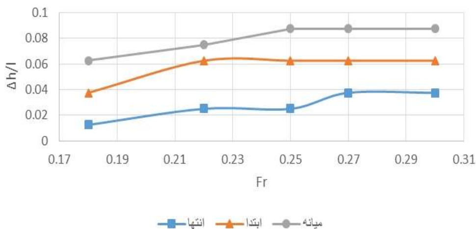
شکل ۸: متوسط اختلاف ارتفاع موج در آرایش زیگزاگ مقطع دایره در ابتدا، میانه و انتهای قوس
