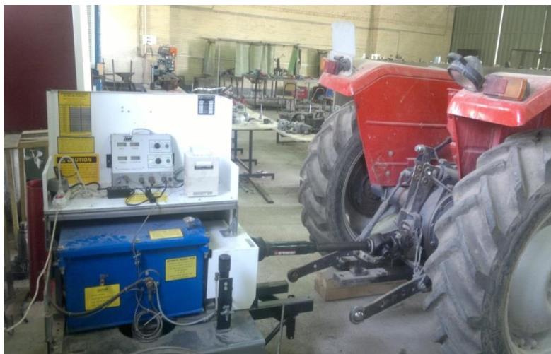
شکل ۲- تصویری از دستگاه دینامومتر متصل به تراکتور
