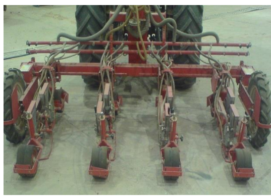
شکل ۱: ریز دانه کار نیوماتیکی گاسپاردو مدل وی ۵ و اجزای واحد کارنده آن شامل: ۱- موزع بذر، ۲- مخزن بذر، ۳- کشک کارنده (شیار باز کن)، ۴- پوشاننده بذر، ۵- چرخ فشار دهنده لاستیکی جلو، ۶- چرخ فشاردهنده لاستیکی عقب، ۷- دستگیره دوار برای تنظیم عمق شیار، ۸- فنر تنظیم فشار شیار باز کن، ۹- کنار ریز کلوخه
