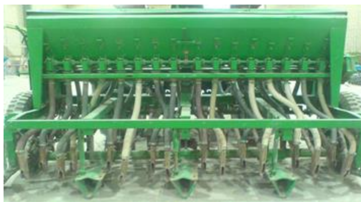
شکل ۲: بذرکار مکانیکی برزگر همدان (خطی کار)
