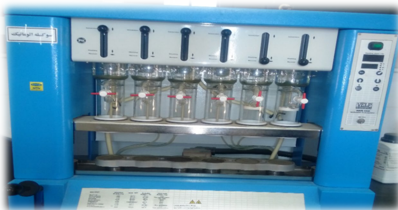
شکل ۱- دستگاه سوکسله اتوماتیک برای اندازه گیری روغن
