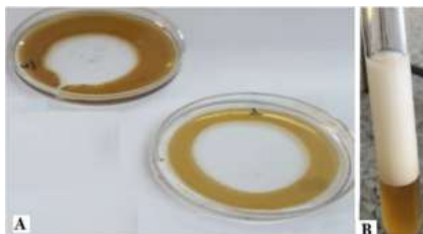
شکل ۱- تصویر آزمون گسترش نفت خام (A) و تصویر شاخص امولسیون‌کنندگی (B)
