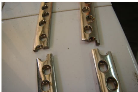
شکل (۱): نمونه‌های شکست شده در بدن انسان برای بررسی نوع شکست توسط میکروسکوپ الکترونی رویشی
