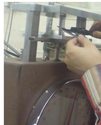
شکل (۲): نیروسنج و فیکسچر متصل به آن جهت تست استاتیکی فنر
