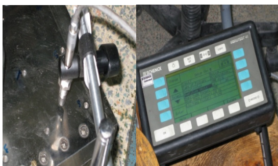
شکل (۱۰): دستگاه Vibrotest 41 به همراه حسگر جابجایی سنج IN-085 (الف) حسگر جابجایی سنج (ب) دستگاه vibrotest41
