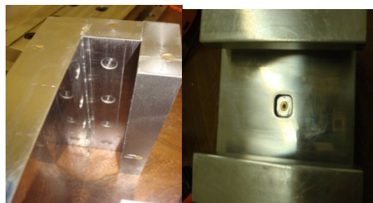
شکل (۹): حوضچه های هوایی میز شماره ۱ و ۲ (الف) حوضچه هوایی ۱ (ب) حوضچه هوایی میز شماره ۲
