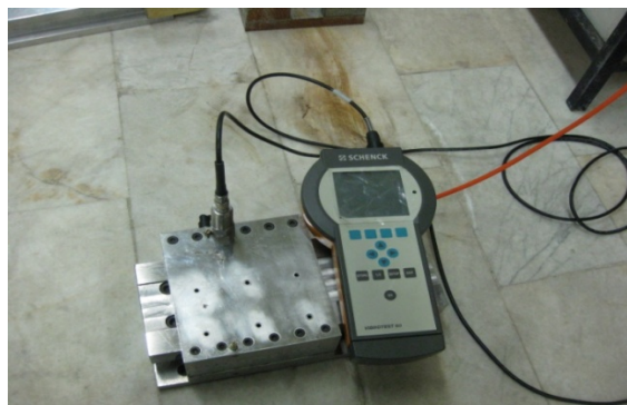
شکل (۱۱): دستگاه vibrotest 60 به همراه حسگر شتاب سنج (AS-06X/07X)
