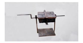
Fig. 3 Picture of Rotating die
