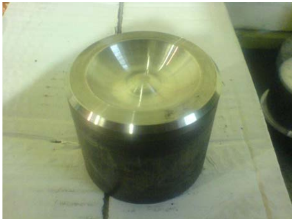
شکل (۲): سنبه و ماتریس ساخته شده در محیط کارگاهی
