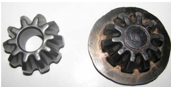
شکل (۳): چرخ دنده های تولید شده به روش آهنگری
