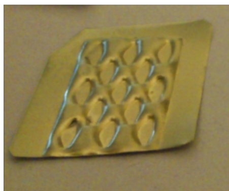
شکل ۴: نمونه پوشش داده شده با نانولایه طلا به روش اسپاترینگ.
