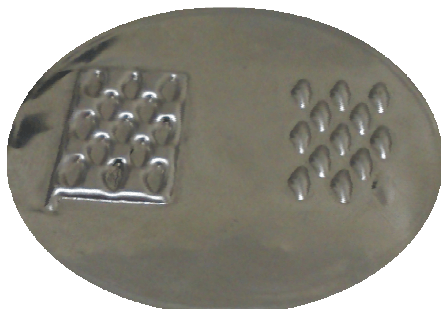
شکل ۳: تصاویری از نمونه‌های صفحات دوقطبی در پیل سوختی بدون پوشش.
