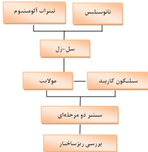
شکل ۱: فلوجارت فرآیند سنتز کامپوزیت مولایت-سیلیکون کاربید.
