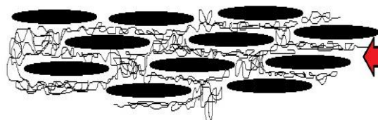
شکل ۶: نفوذ ذرات سوزنی شکل CNC بر روی یکدیگر و تسهیل جریان ذوب LDPE.
